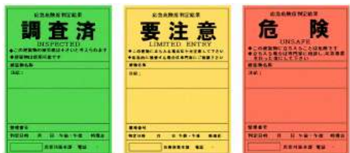
（例）建物の応急危険度判定のステッカー
